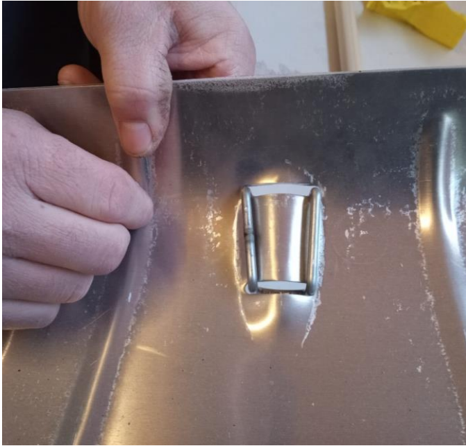
Foto 1. Klem in het blad bevestigen.
