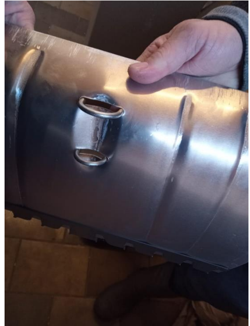
Foto 2. De ringen zitten aan de achterzijde van het blad.
