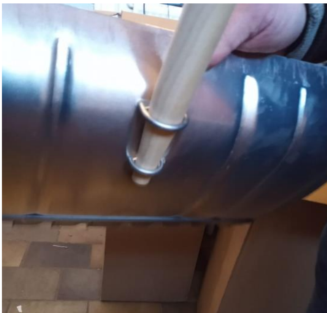
Foto 3. Steel tussen de ringen en het blad steken.
