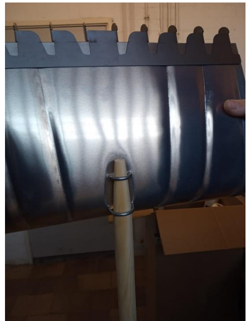
Foto 4. Houd het blad vast met twee handen en sla met de steel enkele malen op de grond. Zo komt de steel klem te zitten tussen het blad en de ringen.
